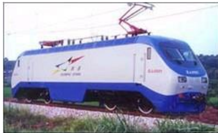
รูปที่ 3.14 รถจักรไฟฟ้าของประเทศจีน ขับเคลื่อนด้วยระบบ AC-DC-AC อินเวอร์เตอร์ใช้ GTO หล่อด้วยน้ำเย็น (ที่มา: http://www.gofront.com )
