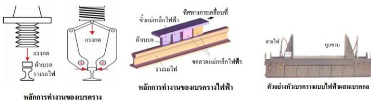
รูปที่ 3.60 หลักการทำงานของเบรกราง
