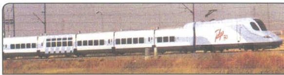
รถโดยสาร 4 ล้อที่ใช้เทคโนโลยี Talgo Pendular ของประเทศสเปน
