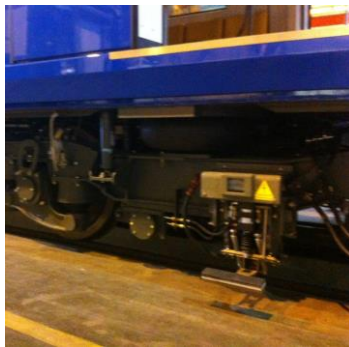
รูปที่ 4.19 ลักษณะของหน้าสัมผัสหรือขาต่อจากรถไฟฟ้า (Shoe)
