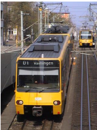
รูปที่ 2.9 รถไฟที่เยอรมนี วิ่งบนรางรถไฟแบบรางผสม
