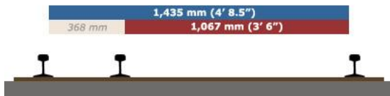
รูปที่ 2.8 แบบการวางรางรถไฟรางร่วมในต่างประเทศ (ที่มา: http://th.wikipedia.org )
