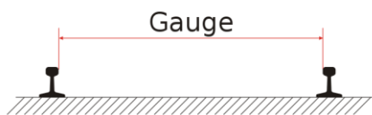
รูปที่ 2.6 ระยะในการวัดขนาดความกว้างรางรถไฟ (ที่มา: http://th.wikipedia.org )
